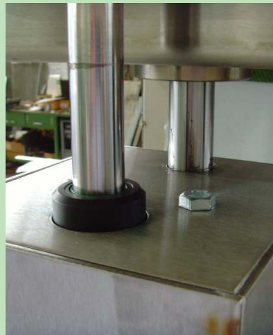
Die pneumatische Hubvorrichtung ermöglicht ein einfaches Entleeren und Heben der Folgeplatte ohne Druckluftunterstützung.
